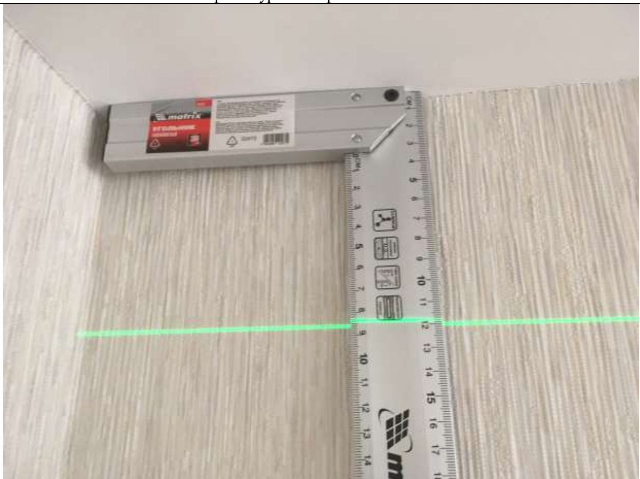
Измерение уровня горизонтали потолка.
