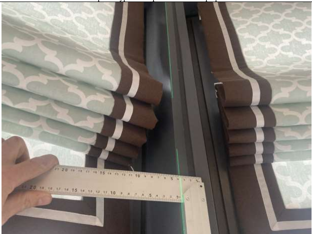
Отклонение от вертикали более 7 мм.
