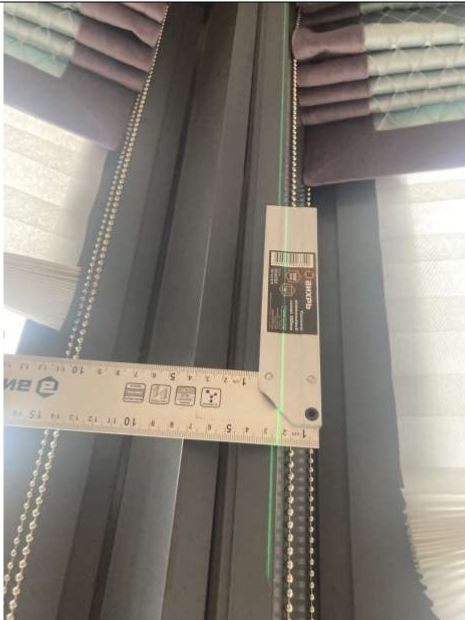
Отклонение от вертикали более 7 мм.
